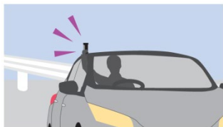
車内からパープルセーバーを設置
